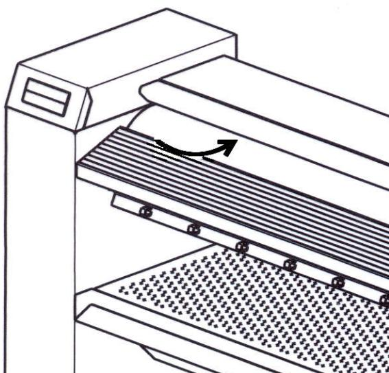
При попадании кончиков пальцев между валом и планкой защиты пальцев гладильный вал сразу останавливается, а мульда отодвигается. При этом индикация символа "Защита пальцев" горит постоянно. В режиме обратного хода вала планка защиты пальцев не функционирует. При необходимости повторного включения гладильного катка можно снова нажать кнопку start "Старт".
