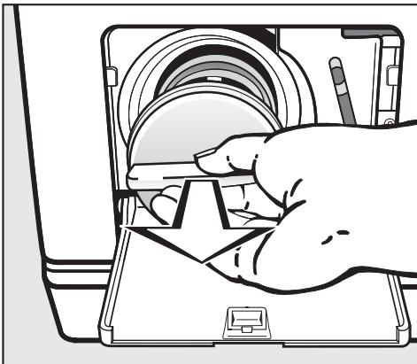
**⚠️** Если фильтр не будет установлен обратно и плотно закручен, вода будет вытекать из стиральной машины.
