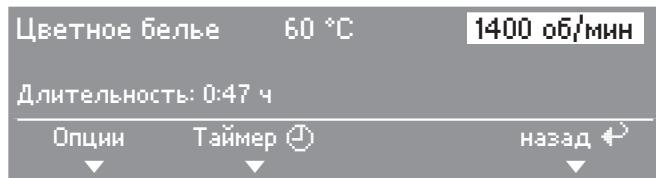
Вращением мультифункционального селектора можно выбрать различные компоненты программы, программу, температуру, скорость отжима. Выбранный компонент выделяется. При нажатии мультифункционального селектора компонент выбирается, и открывается соответствующее подменю.
