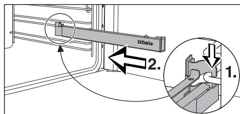
■ Зафиксируйте телескопическую направляющую FlexiClip спереди на верхней опоре уровня (1.) и задвиньте её вдоль опоры в рабочую камеру (2.).
