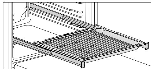
■ Задвиньте универсальный противень с лежащей на нём решёткой на телескопические направляющие FlexiClip. При задвигании решётка автоматически скользит между опорами над телескопическими направляющими FlexiClip.
