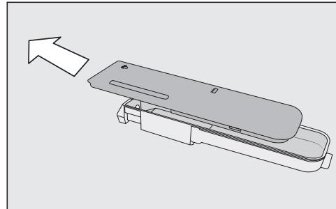
■ Разберите ёмкость для воды на 2 части, вымойте их вручную или в посудомоечной машине.
