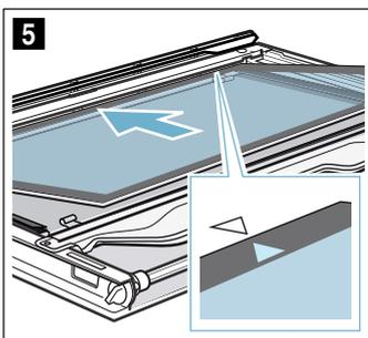
5. Zwischenscheibe im Bereich **b** nach unten drücken, Halterung **c** schräg einschieben und andrücken, bis sie einrastet (Bild **6**). Halterung ist eingesetzt (Bild **7**).
