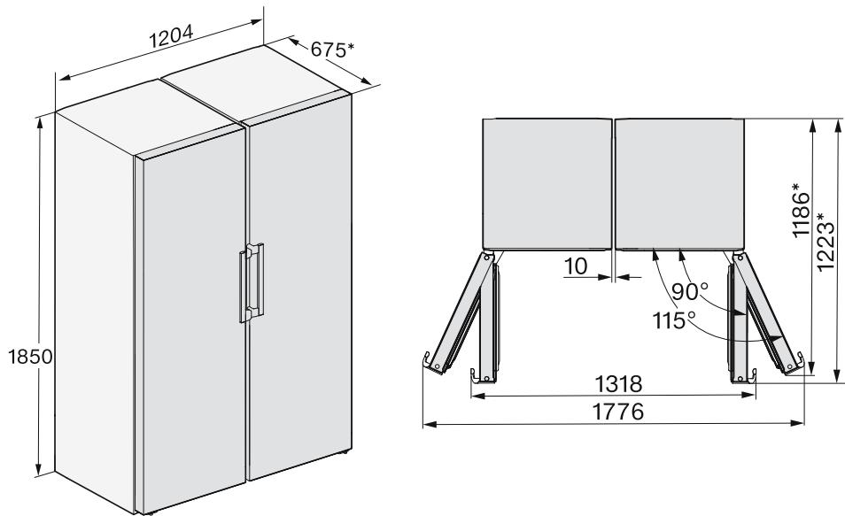
\* Размер без смонтированных прокладок для соблюдения расстояния от стены. При использовании прилагаемых прокладок глубина прибора увеличивается на 15 мм.
