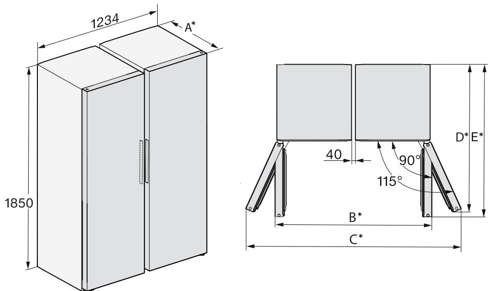
\* Размер без смонтированных проставок для соблюдения расстояния от стены. При использовании прилагаемых проставок глубина прибора увеличивается на 15 мм.
