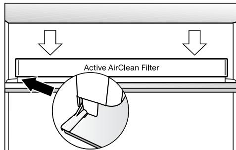
Данный сменный угольный фильтр нейтрализует неприятные запахи в холодильной камере и таким образом способствует улучшению качества воздуха.
