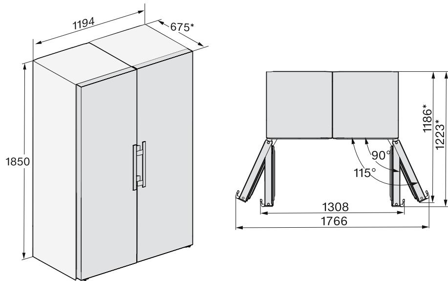
\* Размер без смонтированных приставок для соблюдения расстояния от стены. При использовании прилагаемых приставок глубина прибора увеличивается на 15 мм.
